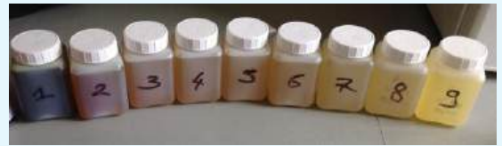
Échantillons produits lors du suivi du nettoyage en place, les phases de débouillage et premières phases de rinçage contiennent la majorité de la charge polluante.
